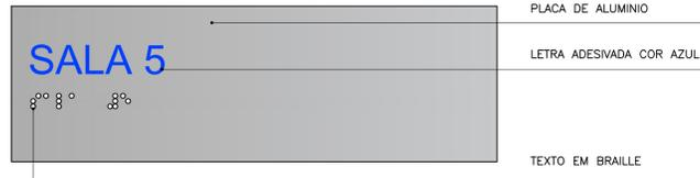
PLACA DE ALUMÍNIO ANODIZADO ESCOVADO LETRA EM VINIL RECORTADO COLANTE COR AZUL E PUNÇIONAMENTO DE PONTOS BRAILLE
